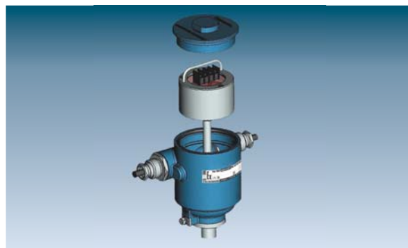
Рис. 2. Демонтаж чувствительного элемента.
