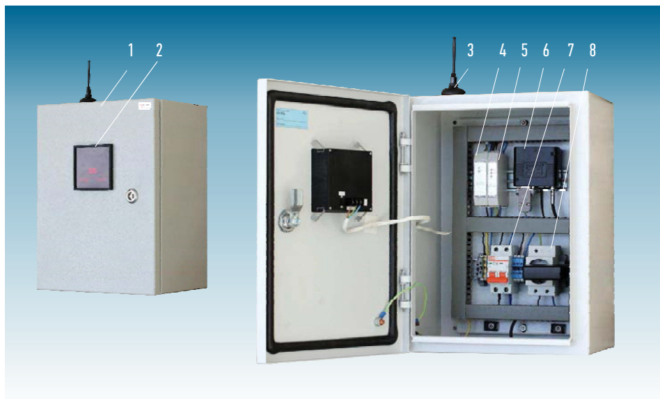
Рис. 11. Вариант поставки комплекта вторичных приборов для комплектации системы удаленного доступа в шкафу IP54: 1 - Шкаф "ШУ-IP54", 2 - Сигнализатор "МС-К-500-2С", 3 - Антенна GSM, 4 - Блок питания "БП-9В-0,4А", 5 - Адаптер "ЛИН-Модем-DIN", 6 - GSM-модем, 7 - Выключатель сетевой, 8 - Розетка для вилки шнура питания GSM - модема.
