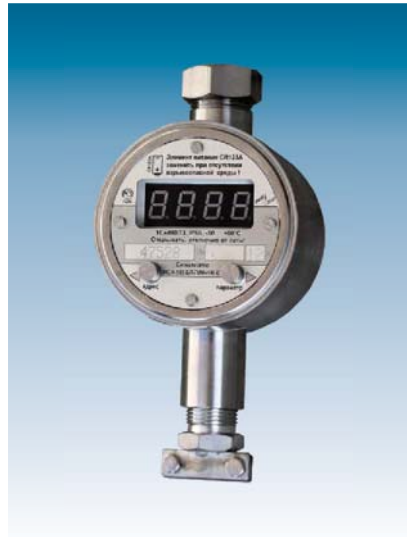
Рис. 11. Сигнализатор МС-К-500-БП-ЛИН-НЖ-В3 имеет встроенный элемент питания, предназначен для применения в автономных системах измерения. По сравнению с сигнализатором МС-К-500-БП-ЛИН-В3 (рис. 10) корпус выполнен из стали 12Х18Н10Т, полость корпуса заполнена компаундом.
