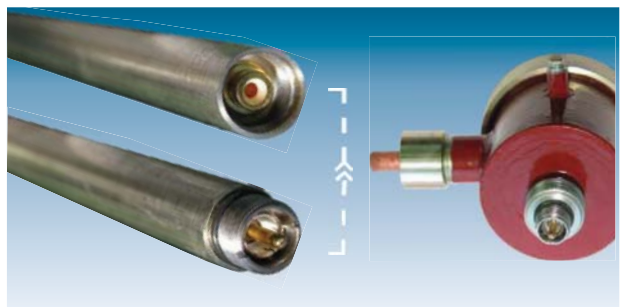
Рис. 3. Коаксиальные разъемы в сочленениях составных частей ПМП.
