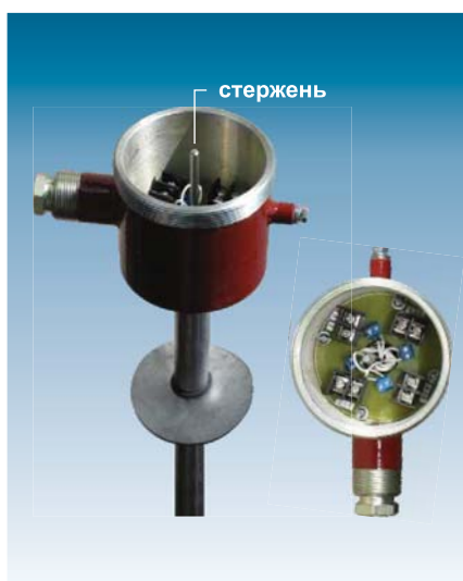
Рис.5 ПМП-152. Внешний вид. На стержне крепятся платы герконов, которые можно передвигать для настройки уровней.
