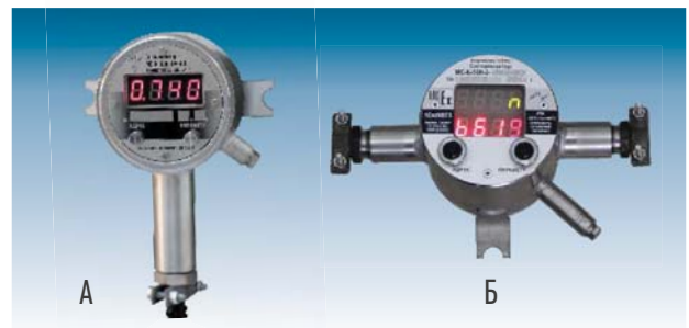
Рис. 14. Сигнализатор МС-К-500(-2)-НЖ (рис. А) имеет корпус, выполненный из стали 12Х18Н10Т, полость корпуса заполнена компаундом, МС-К-500-2-НЖ2 (рис. Б) имеет корпус, выполненный из стали 12Х18Н10Т, вид взрывозащиты "d" улучшает удобство подключения и ремонтпригодность
